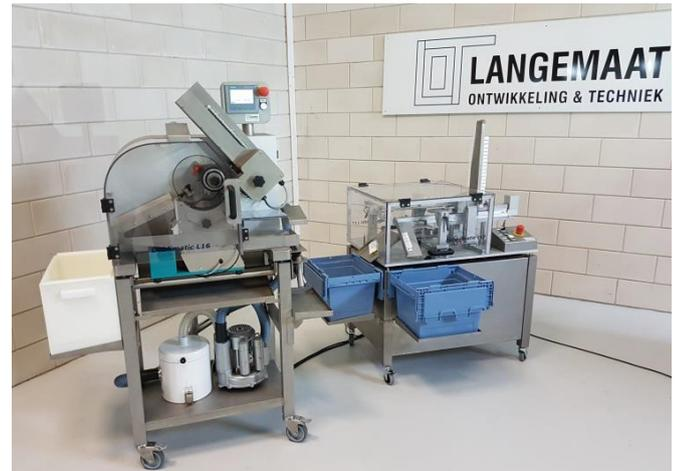
Eine Deboxmatic-Maschine kann mindestens einen, je nach Blisterzahl auch zwei Deblimatic-Entblisterer befüllen. Im obigen Bild können die Blister von der Deboxmatic (rechts) sofort in den Deblimatic-Entblisterer (links) gefüllt werden.
