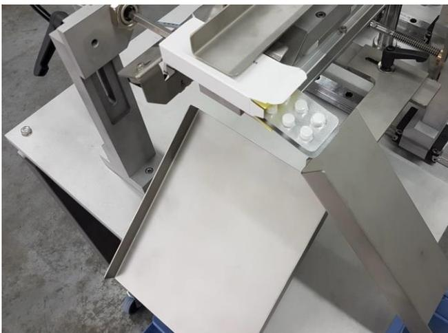
Das obige Bild zeigt einen Schritt im Arbeitszyklus der Deboxmatic-Maschine, Blister werden aus einer Verpackung entfernt. Kurz darauf im Zyklus fallen die Blister auf die Rutsche auf der rechten Seite und rutschen in einen Kunststoffbehälter.
