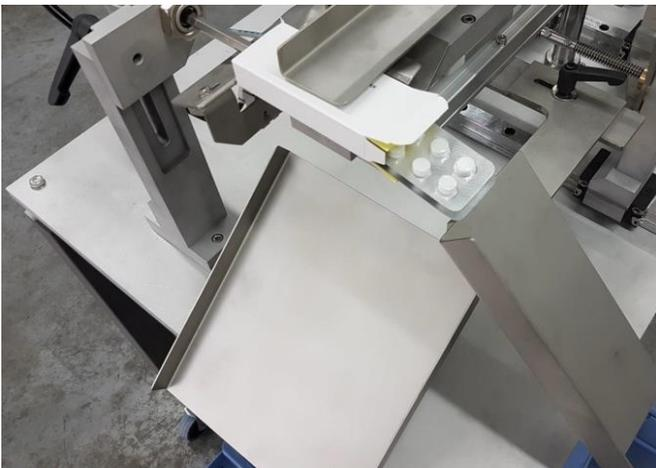
L'image ci-dessus montre une étape lors du cycle de fonctionnement de la Deboxmatic, où les ampoules sont poussées hors d'une boîte. Une fraction de secondes plus tard pendant le cycle les ampoules tomberont sur la trémie du côté droit et glisseront dans une boîte en plastique.
